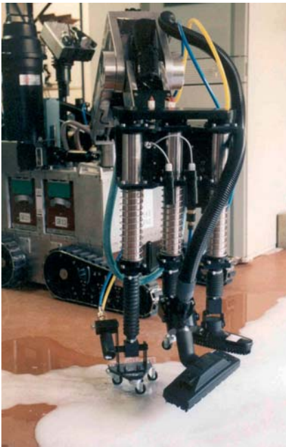
Obr.4 MT – 15 s dekontaminačnou nadstavbou
